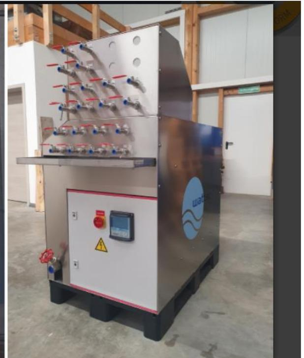
von links: Bediendisplay des Dreyproper 4.2 zur Steuerung und Überwachung des Reinigungsprozesses in den Kühlkanälen von Spritzguss-Werkzeugformen. | Bis zu zwölf Kühlkanäle können gleichzeitig angeschlossen und gereinigt werden; der Reinigungsprozess kann um rund 50 % beschleunigt werden. 2 / 3
